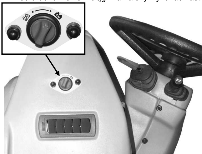
Rysunek 5-1 Włącznik akumulatora wewnątrz kabiny ciągnika.
