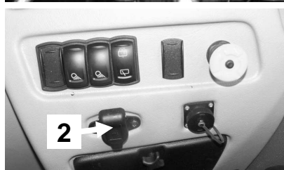
Rysunek 5-29 Złącze 1 instalacji elektrycznej dla przyczep i gniazdo 2 zasilania +12V 20A dodatkowych odbiorników dołączonych do instalacji elektrycznej ciągnika.
