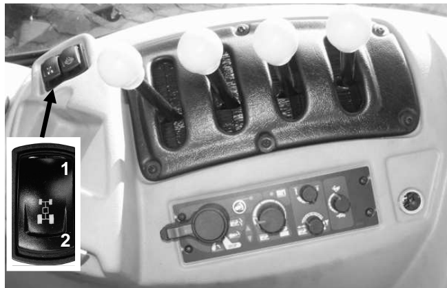
Rysunek 4-26 Włacznik sterowania napędem przedniego mostu można ustawić w dwóch położeniach: 1 - napęd wyłączony (górne); 2 - napęd włączony (dolne).
