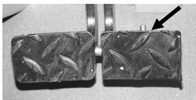
Rysunek 4-24 Zapadka blokująca pedały hamulca roboczego.
