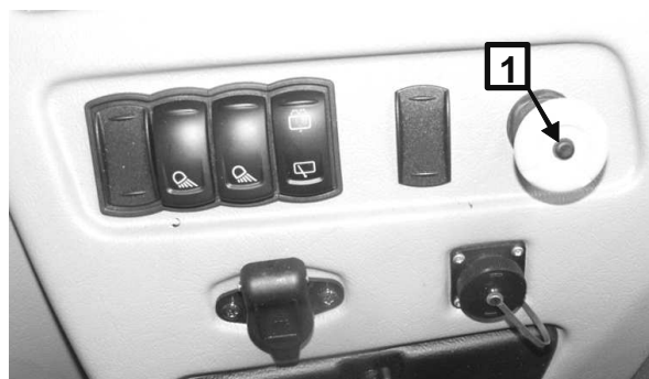
Rysunek 4-30 Włącznik WOM-u w ciągnikach PRONAR i sposób włączania napędu WOM. 1- włącznik tylnego WOM
